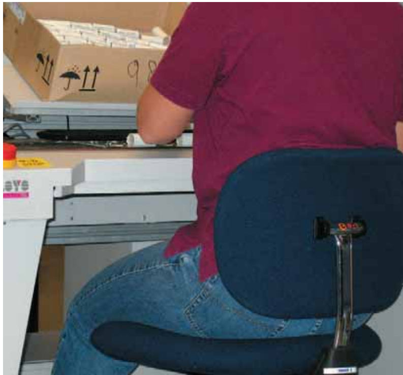
Højdeindstillelig arbejdsplads ved conveyerbane. En elektronisk stopliste sikrer, at bordet stopper, hvis det rammer medarbejderens lår.
